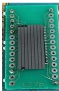
図1 製作したCdTe検出器
