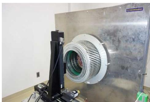
図2 3次元半導体PETのプロトタイプ
